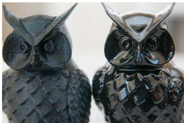
*Figura 10 – Um objeto impresso em 3D, antes e depois do alisamento de vapor*
