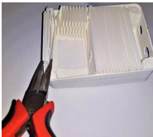
*Figura 7 – Remoção das estruturas de suporte*
