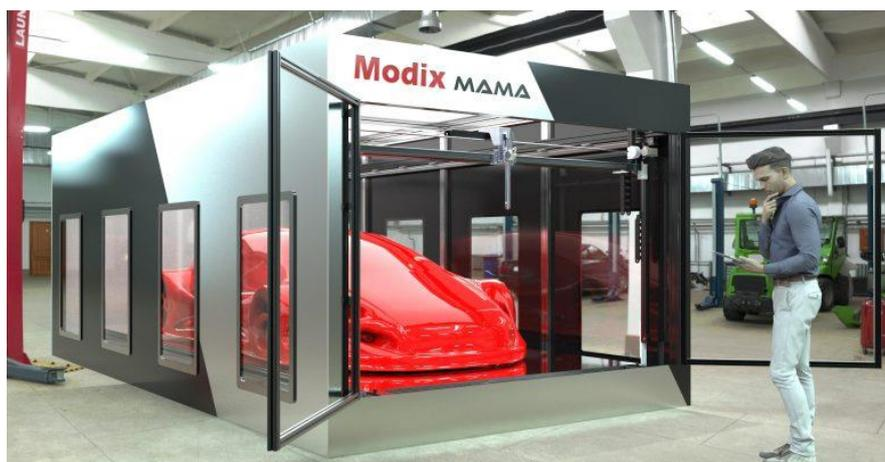
Figura 26 - Conceito para uma grande impressora 3D. Fonte: modix3d.com
